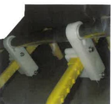
4. Insérer les vis avec leur rondelle dans les trous du bras et procéder de même pour le second échelon
