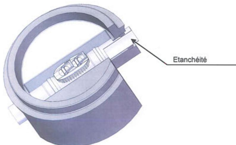
Figure 16 – Utilisation du raccord d'accès scellé dans un regard – Schéma d'installation
