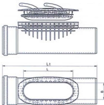
Figure 14 – raccord d'accès scellé POLO-ECO plus PREMIUM
