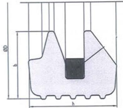
Figure 4 - Garniture d'étanchéité Système DD
