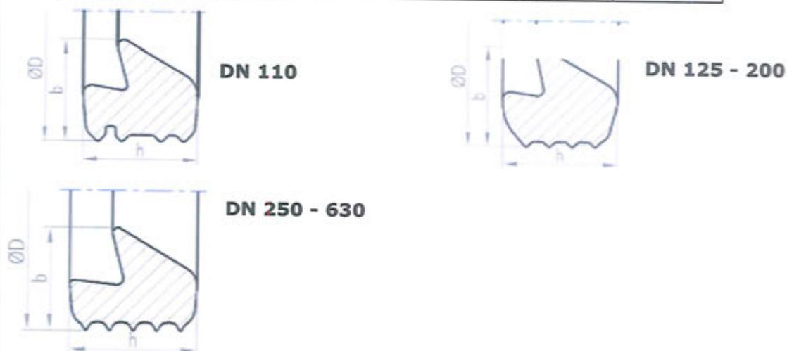
**Figure 3 - Garniture d'étanchéité Système BL**
