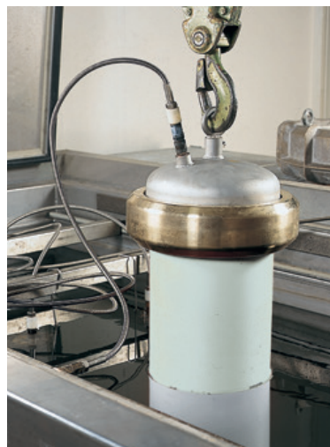
Essai de tenue à long terme (ILLUSTRATION 18)
