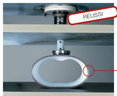
Essai de charge ponctuelle avec entaille latérale (ILLUSTRATION 2)
