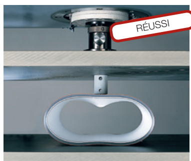
Essai de perforation avec poinçon (ILLUSTRATION 1)
