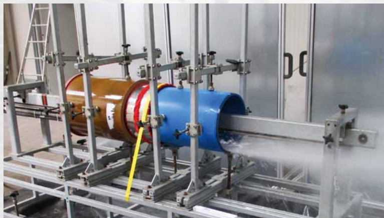
Test de rinçage haute pression selon la norme DIN 19523 dans les locaux de la société iro GmbH, à Oldenburg
