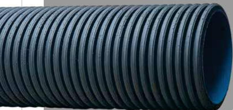
Tube en PEHD (Polyéthylène Haute Densité) annelé à double paroi (noire externe et bleue interne) «MAGNUM» pour réseaux gravitaires enterrés, bénéficiant d'un certificat **NF EN 13476-3**, de classe de rigidité SN8 selon la **NF EN 9969** (rigidité annulaire supérieure à 8 kN/m<sup>2</sup>).
